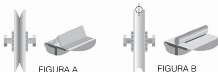
3. Asegúrese de que la hoja de la puerta no se atasca durante la apertura y el cierre. El carril de deslizamiento de la puerta debe ser perfectamente recto, nivelado, periódicamente claro de cualquier elemento o suciedad que impide el deslizamiento de los rodillos a lo largo de su longitud, como se muestra a continuación:
