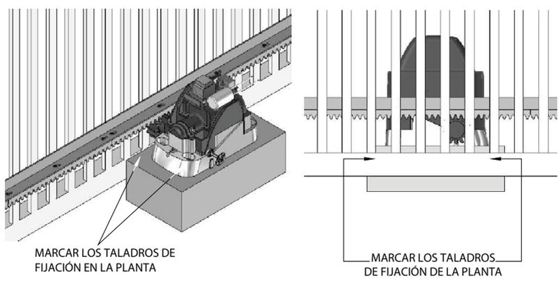
**Paso 5:** Haga el taladro para la fijación, posicionando el automatizador alineado a la puerta. Antes de apretar los tornillos S ¼ "x 2 ½", mueva la puerta para verificar que no toca el automatizador durante su recorrido. Si esto ocurre, retroceda el automatizador.
