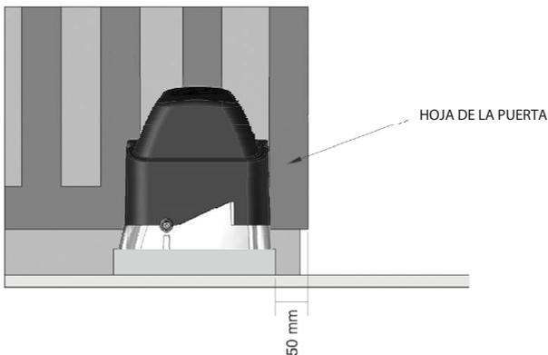
**Paso 4:** Haga la pre-alineación del automatizador a la puerta, posicionando la rejilla en el engranaje. A continuación, marque los agujeros de fijación en el suelo o base de hormigón.
