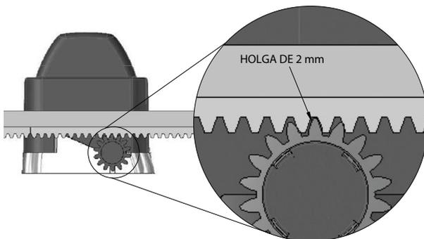
**Paso 7:** Fije la cremallera en toda la longitud de la hoja de la puerta por soldadura o tornillo a cada 300 o 400 mm.
