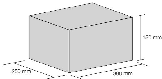
**Paso 2:** Las dimensiones de la base deben ser apropiadas para las dimensiones del automatizador. La base de hormigón debe estar a una distancia de aproximadamente 20 mm de la parte de la hoja de la puerta.
