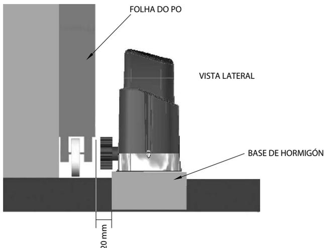
**Paso 3:** Luego, abra totalmente la puerta y posicione el automatizador cerca de la parte de la hoja de la puerta, considerando la medida de 50 mm entre el borde de la hoja y el automatizador.
