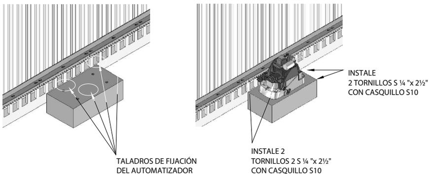
**Paso 6:** Con el automatizador desbloqueado, posicione la barra de cremallera en el engranaje alineada a la puerta. Es necesario dejar una distancia de aproximadamente 2 mm entre la parte superior del diente del engranaje y el fondo de la cremallera.
