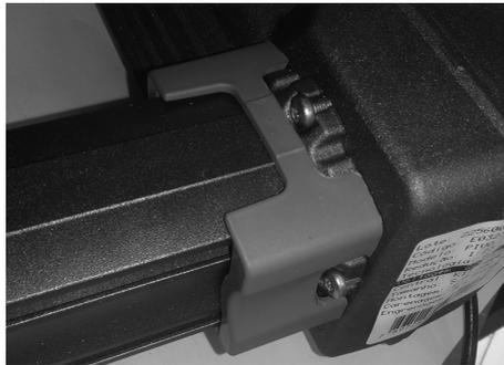
Finalmente, coloque la planchuela de fijación del accionador en el émbolo con el tornillo, ajustando la tuerca lo suficiente como para que quede algo de juego.<sup>2</sup>
