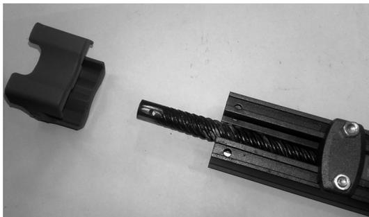
Inserte el tornillo del accionador en el eje del motorreductor, pase el tornillo de ajuste y colóquelo la tuerca provista.<sup>1</sup>
