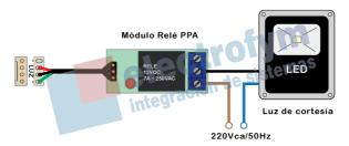
Si se lo desea, en vez de utilizar una luz de cortesía, puede utilizarse un semáforo y programar el tiempo al nivel 0 (para esto deberá solicitarse dicha programación previamente, solicitar la atención de un técnico especializado si se está en la zona o adquirir un programador PROG) de tal manera que se apague inmediatamente al cerrar el portón. El esquema de conexión con un semáforo de 4 hilos será el siguiente:
